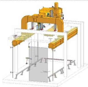
Fig. 1: Instalación de descongelación
